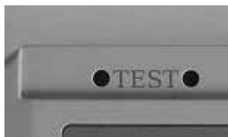
Deux trous se trouvent sur le bord supérieur du boîtier. Retirez le capot de protection de l'appareil puis enfoncez les aiguilles dans les perforations. La valeur 19 % doit s'afficher sur l'écran, indiquant un calibrage correct. Si ce n'est pas le cas, l'appareil doit être expédié au service après-vente de la société STORCH GMBH.
