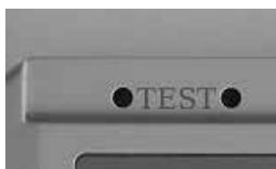
Aan de bovenrand van de behuizing bevinden zich twee boringen. Trek de beschermkap van het apparaat en steek de meetnaalden in de boring. Op het display moet de waarde 19% worden aangegeven, zodat een correcte kalibratie is gegarandeerd. Bij afwijking van de waarde moet het apparaat voor nieuwe afstelling naar de klantenservice van STORCH GmbH worden verzonden.
