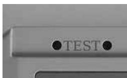
Na hořejším okraji tělesa se nacházejí dva vývrtky. Odstraňte ochranný kryt přístroje a do vývrtů zastrčte měřicí jehly. Aby byla zaručena korektní kalibrace musí se nyní na displeji objevit hodnota 19 %. Při odchylce hodnoty musí být přístroj zaslán do zákaznického servisu STORCh GmbH k nové justáži.
