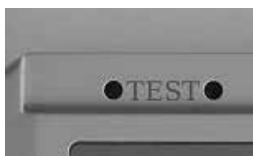
Al bordo superiore dell'alloggiamento ci sono due forature. Togliere il cappuccio di protezione dall'apparecchio ed inserire le punte di misurazione nelle forature. Il display dovrebbe indicare un valore di 19 % per garantire una calibrazione corretta. Nel caso di variazioni da questo valore occorre inviarlo all'assistenza clienti della STORCH GMBH per farlo riaggiustare.
